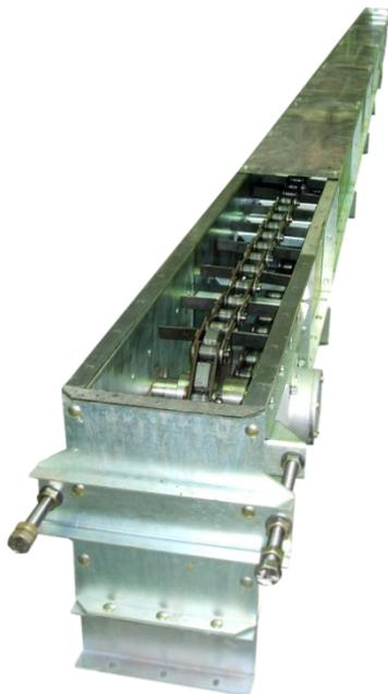
Конвейеры скребковые с погруженными скребками предназначены для горизонтального и полого-наклонного до 15° транспортирования зерна и продуктов его переработки на зерноперерабатывающих предприятиях, в приемных отделениях железнодорожного и автомобильного транспорта, а также в надсилосных и подсилосных галереях элеваторов, мельниц, крупяных, комбикормовых, маслоэкстракционных заводов и других предприятиях, связанных с приемом, хранением и переработкой зерна или маслосемян.
